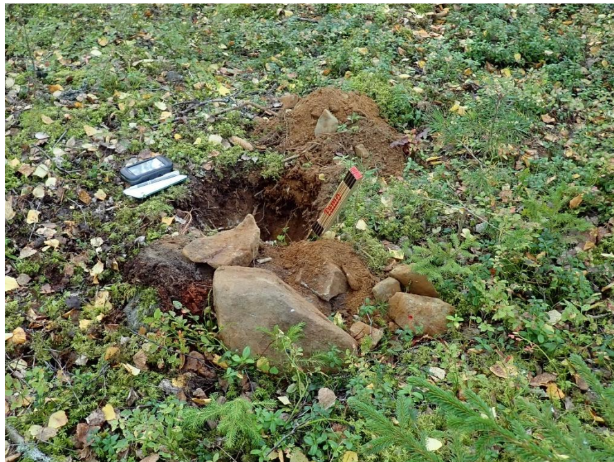
Kuva 5. Koekuoppa 1. Kuopassa oli isoja kiviä muutaman kymmenen sentin syvyydellä maanpinnasta.
